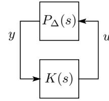
図 2: フィードバック系:  $P_\Delta(s) \in \mathcal{P}$ ,  $K(s)$  はそれぞれ制御対象および制御器の伝達関数を表す．
