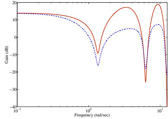
図 3: デジタル繰り返し制御器、ノミナルモデルに対する制御器 (実線) とロバスト制御器 (破線)。
