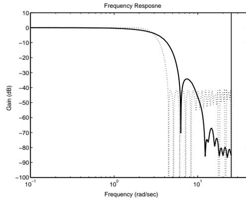
Fig. 8: AD 変換器におけるデシメーションフィルタ: サンプル値  $H^\infty$  設計（実線），等リップルフィルタ（点線）
