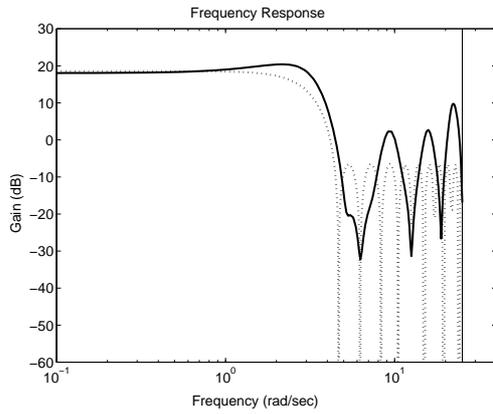
Fig. 10: DA 変換器におけるインターポレーションフィルタ: サンプル値  $H^\infty$  設計 (実線), 等リップルフィルタ (点線)
