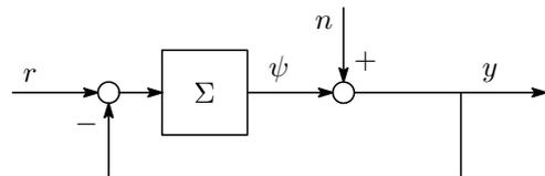
Fig. 2:  $\Delta\Sigma$  変調器の線形モデル
